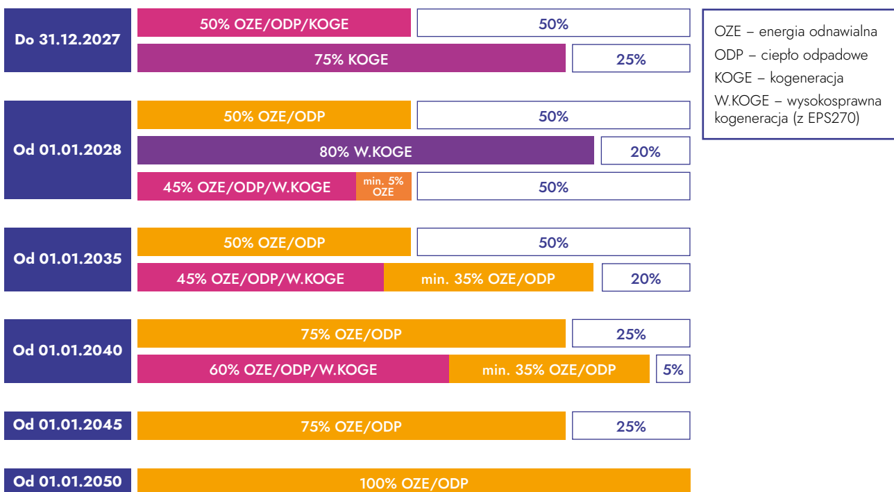
Rys. 11. Nowe kryteria dla efektywnych systemów ciepłowniczych
